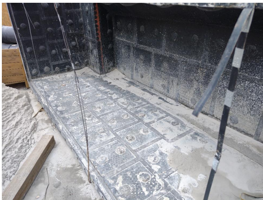
Figura 1-12. Cajón de traspaso convencionales previo a su instalación
