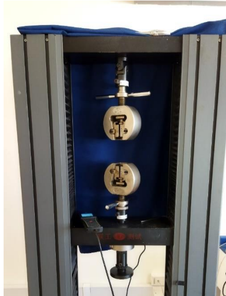
Figura 3-10 máquina para análisis de tracción
