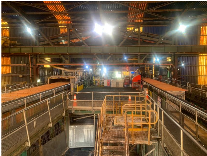
Fig. 6: Vista General de la Máquina Despegadora de Cátodos de Centinela. Se puede observar a la izquierda de la imagen la zona de alimentación del equipo (cadena de alimentación), y a la derecha la cadena de salida de Placas de inoxidable sin cobre, las cuales recirculan al proceso de depósito.
