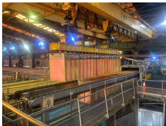
Fig. 5: Puente de Cosecha alimentando con Placas con Cobre a la MLDC.
