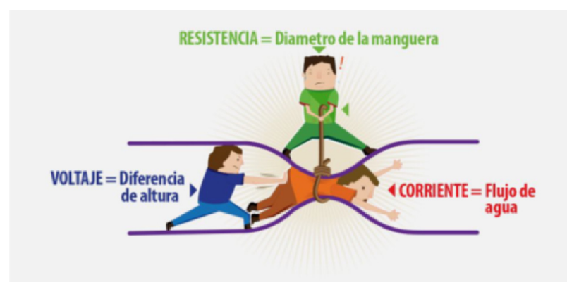
Figura A.6: Analogía relación voltaje- corriente- resistencia.
