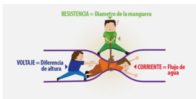
Figura B.4: Analogía relación voltaje- corriente- resistencia.
