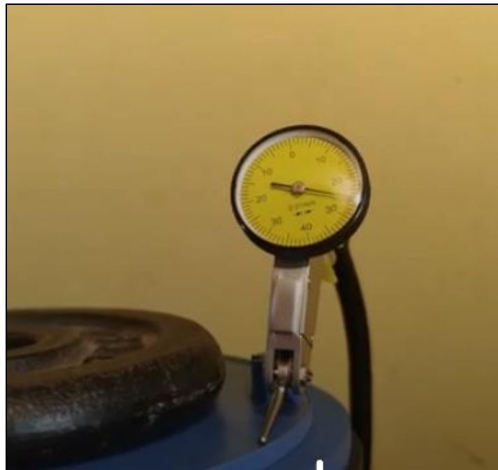
Figura 45. Medición altura máxima a carga de 1,041[kg].
