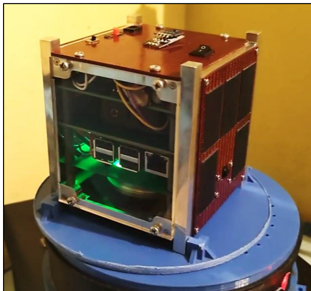
Figura 49. Prueba de ADCS Cubesat, fallo por desplazamiento hacia el borde izquierdo.
