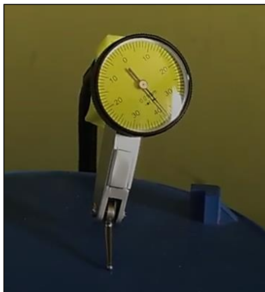
Figura 41. Medición altura sin carga (0,117[ kg]) 37 micrómetros.
