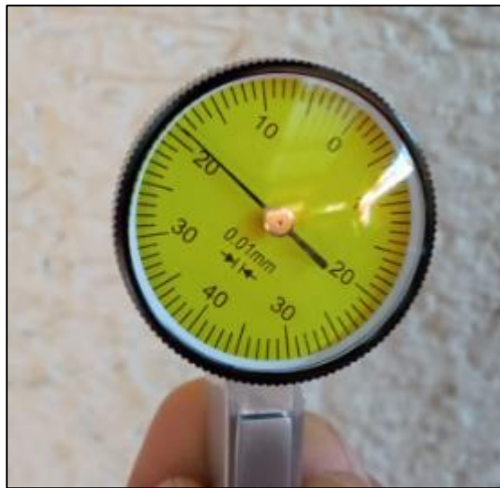
Figura 38. Indicador de prueba horizontal, 0,01[mm].
