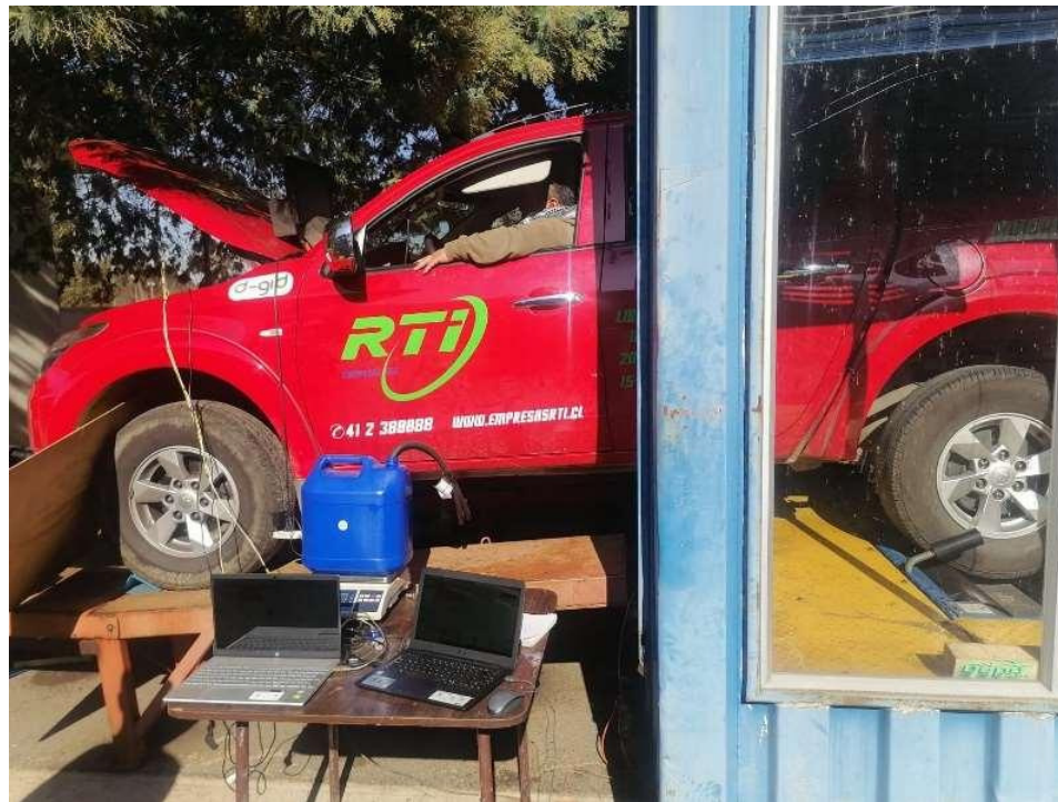
Figura 5.3. Camioneta montada en el freno y sistemas de adquisición de datos.
