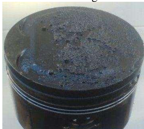
Figura 1.2. Daños en un pistón debido a knock intenso. Obtenido de [4].
