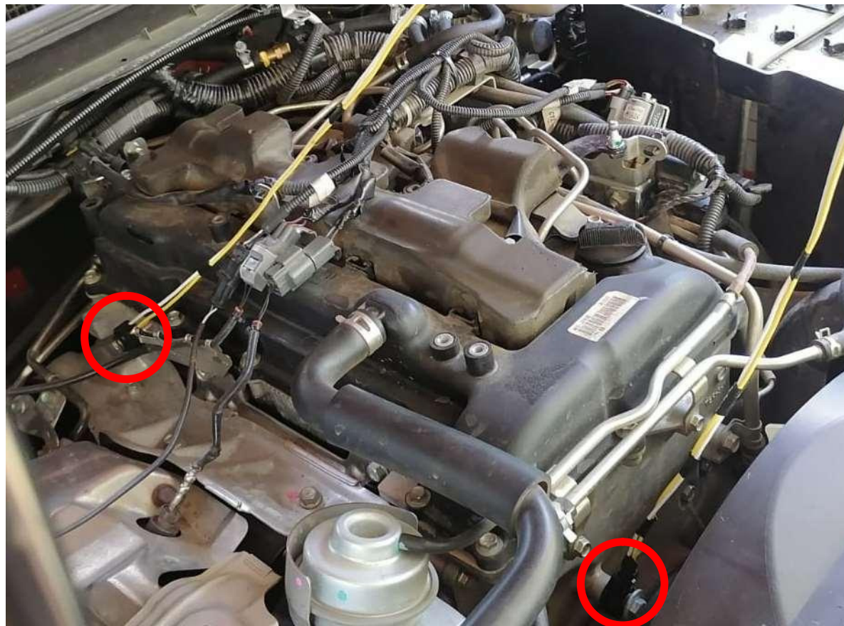
Figura 5.2. Ubicación de los sensores de knock. El sensor A corresponde al de la derecha y el B al de la izquierda.
