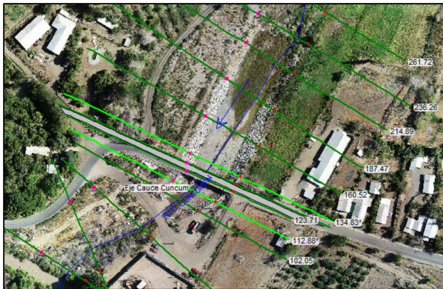
Figura 4-4: Secciones interpoladas para la contracción y expansión
