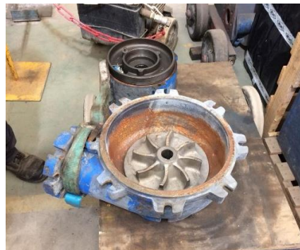
Figura 2-5 Bomba de lodo en mantención
