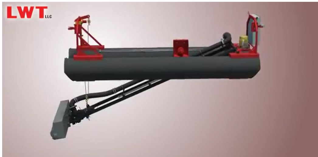
Figura 2-1 Bomba tipo draga radio controlada
