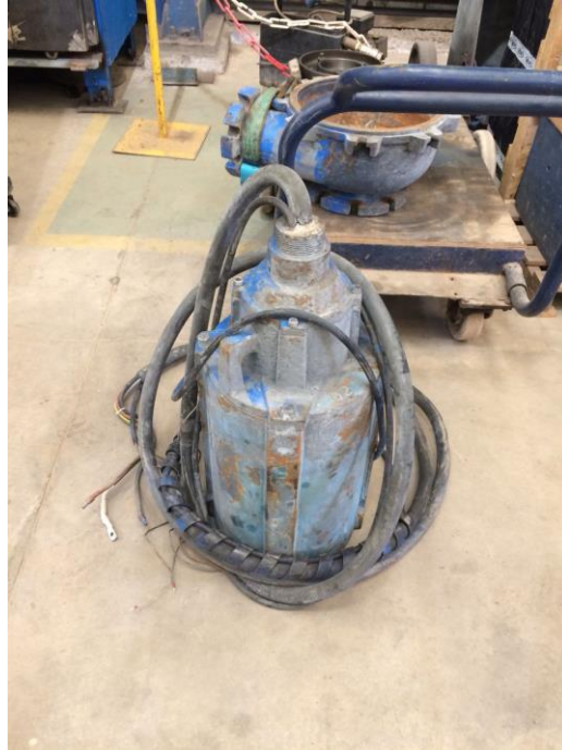
Figura 2-10 Motor eléctrico de bomba de lodo
