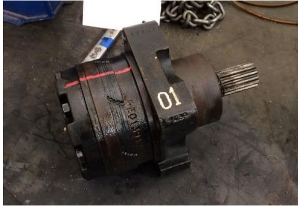
Figura 2-8 Motor hidráulico #1 barrenadora
