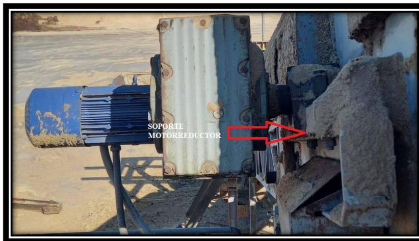
Figura 3- 2 Soporte motorreductor
