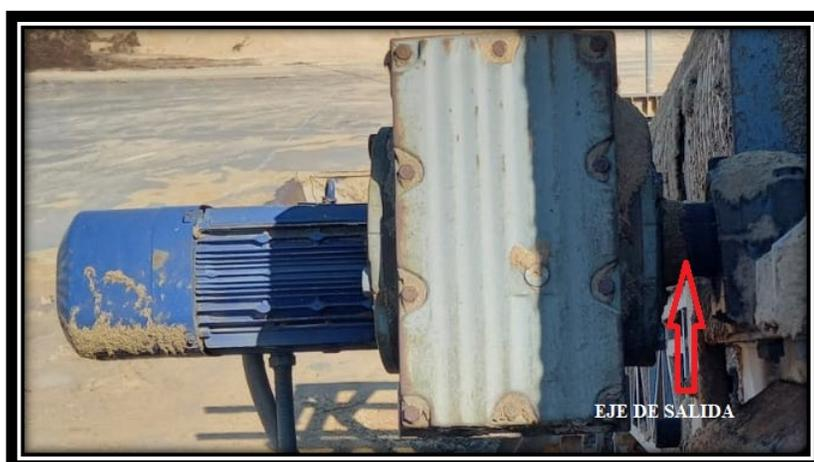
*Figura 3- 3 Eje de salida*
