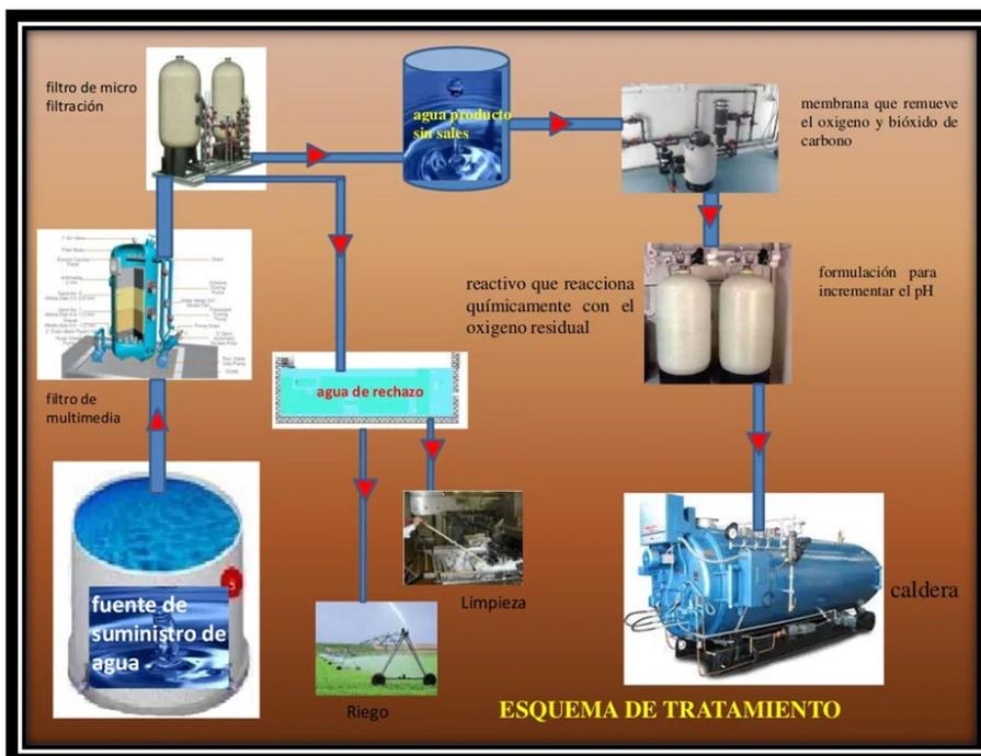
Figura 1- 10 Esquema de tratamiento de agua de la caldera
