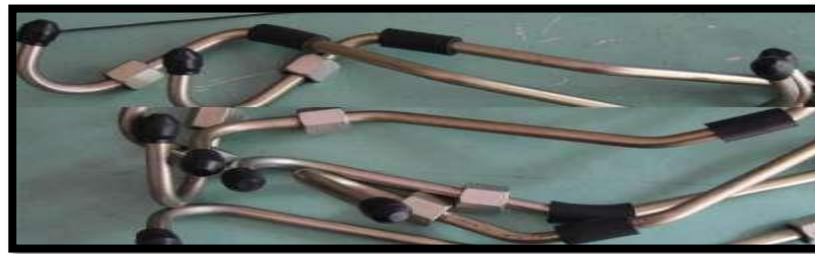
Figura 2.18 Cañerías de presión
