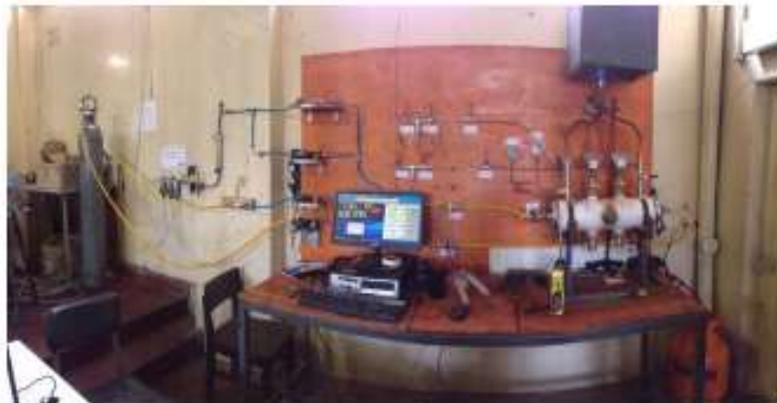
Figura 24. Instalación de un quemador de medios porosos inerte para pruebas experimentales.
