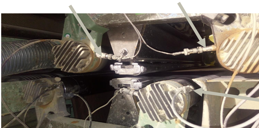
Figura N°9, Sensores de Vibración Reenvíos
