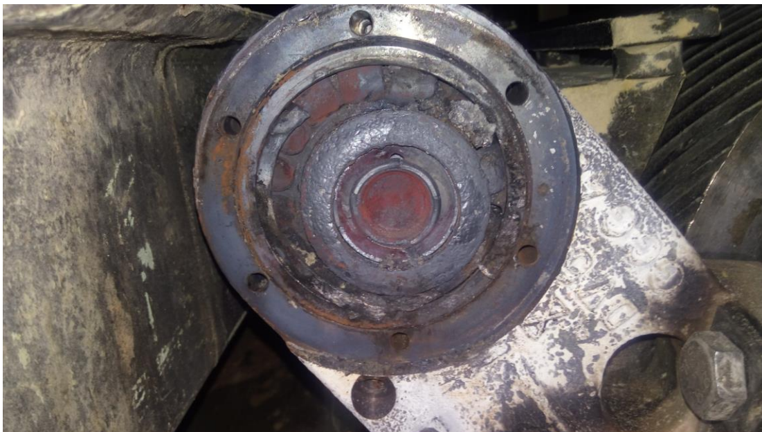
Figura N°8, Falla rodillo reenvió por falta de inspección
