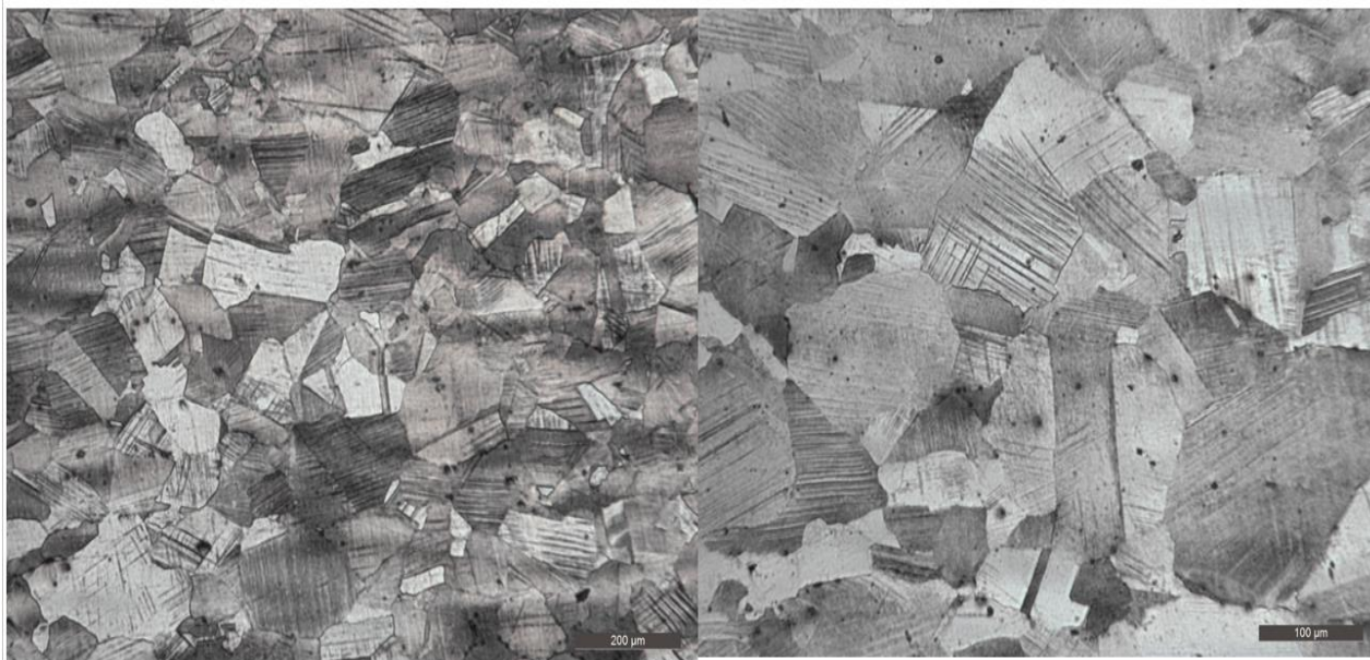
Figura 4.1 Análisis metalográfico en materiales en condición inicial de ensayo. Vista Superficial. Reactivo Nital 2%. Izquierda 50x. Derecha 100x.
