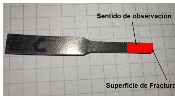
Figura 4.12 Análisis metalográfico en probetas de tracción. Indicación del sentido de observación adoptado.
