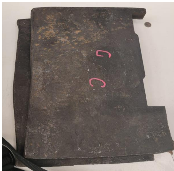
Figura 3.5 Vista general de una de las placas obtenidas luego de finalizar el tratamiento Termomecánico.
