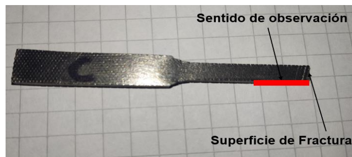
Figura 4.14 Análisis metalográfico en probetas de tracción. Indicación del sentido de observación adoptado (sentido de tracción).
