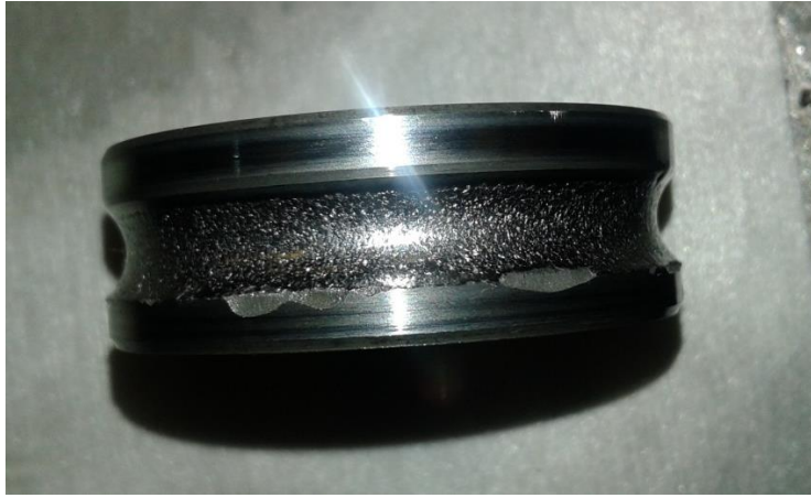
Foto 6: Desgaste cubeta interior rodamiento. Planta N°1 PF alimentos. Fotografiada por Rodrigo Zuzarte, en taller de mantención PF planta N°1
