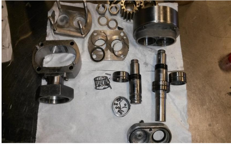
Foto 3: Despiece bomba dosificadora. Planta N°1 PF alimentos.
