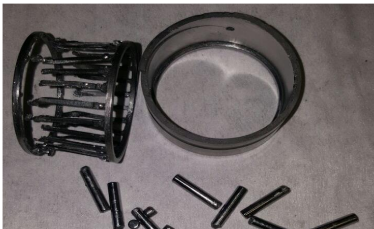
Foto 8: Daño en jaula rodamiento. Planta N°1 PF alimentos. Fotografiada por Rodrigo Zuzarte, en taller de mantención PF planta N°1
