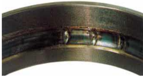
Figura 9: Anillo externo, alteración de color de la pista y marcas en los intervalos de las bolas.
