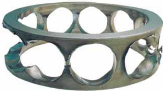
Figura 6: Jaula de rodamiento de contacto angular, fracturada y desgastada en los pilares.
