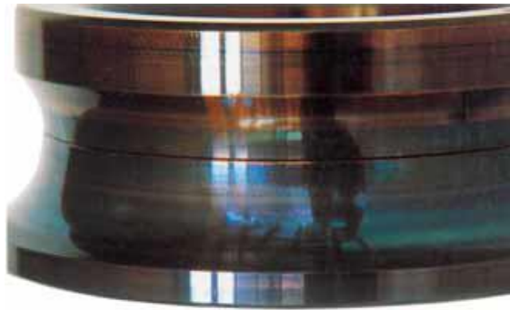
Figura 11: Anillo externo de rodamiento de contacto angular con alteración de color de la superficie de la pista producto del calor. Catálogo de fallas de rodamientos NSK.
