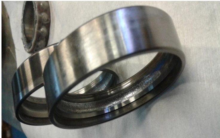
Foto 7: Desgaste cubeta exterior rodamiento. Planta N°1 PFalimentos. Fotografiada por Rodrigo Zuzarte, en taller de mantención PF planta N°1
