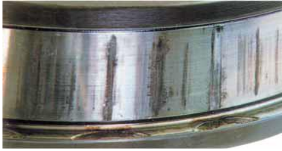
Figura 8: Anillo interno de rodamiento de hileras de rodillos cónicos con deterioro en la pista por carga excesiva.
