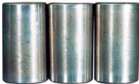
Figura 7: Rodillos con abolladuras en la superficie de rodaje.
