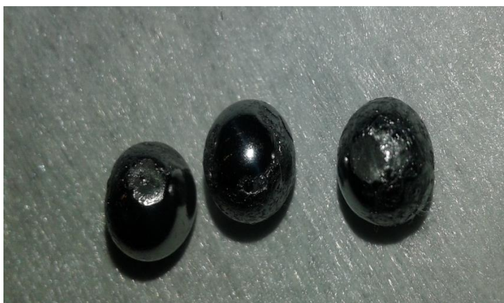
Foto 5: Daño en esferas de rodamiento. Planta N°1 PFalimentos.
