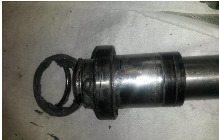
Foto 4: Rodamiento dañado, montado en eje. Planta N°1 PFalimentos.
