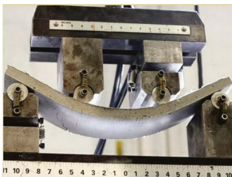
Figura 2-2. Ensayo de tracción del bio hormigón.
