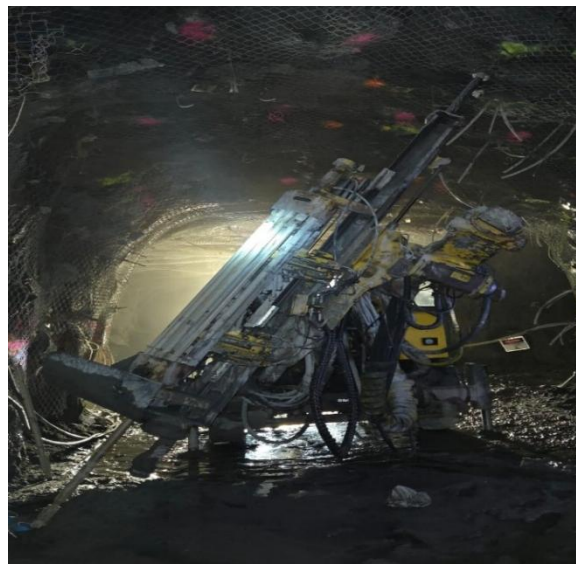
Figura 4: Simba en postura de perforación.
