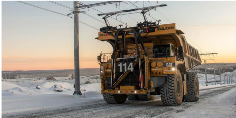
Figura 10. Sistema de pantógrafos en contacto con las catenarias.
