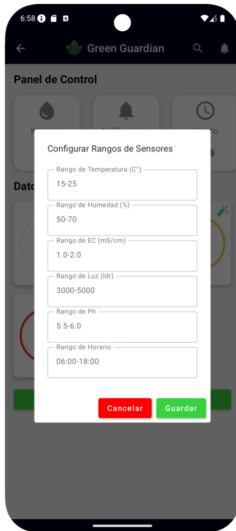
Figura 15: Configuración de Sensores. Fuente: Elaboración Propia.
