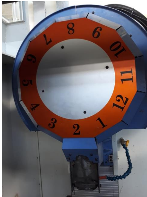
Figura 1-8: Cabezal del centro de perforado LEADWELL TDC-5100, de la UTFSM sede Viña del mar
