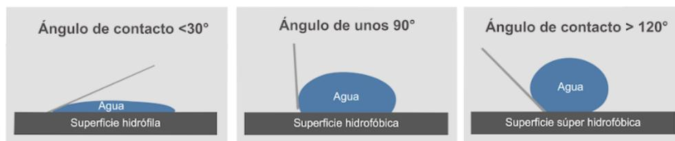
**Figura 10. Significado ángulo de contacto, según tipo de superficie.**
