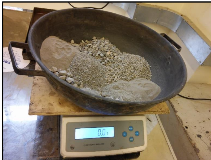
Figura 6: Dosificación de agregados pétreos
