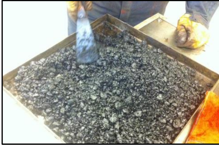
Figura 9: Colocación de mezcla sobre bandeja.
