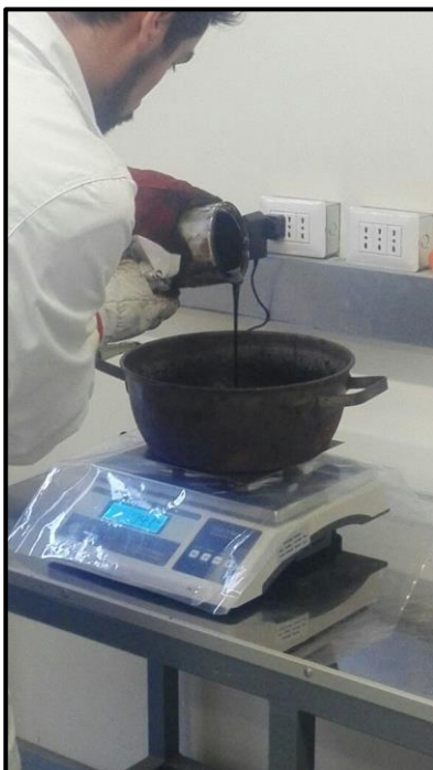
Figura 7: Incorporación de asfalto a la mezcla de agregados.
