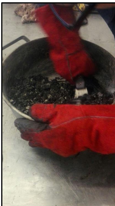
Figura 8: Mezcla de ligante asfáltico y agregados.
