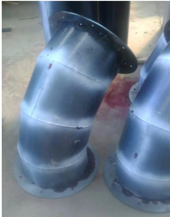
Figura 2-1. Inspección tintas penetrantes – Angloamerican.
