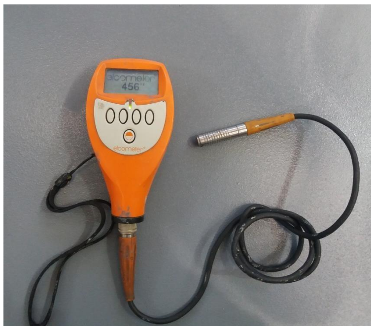
Figura 2-12. Medidor espesor pinturas Elcometer 45.
