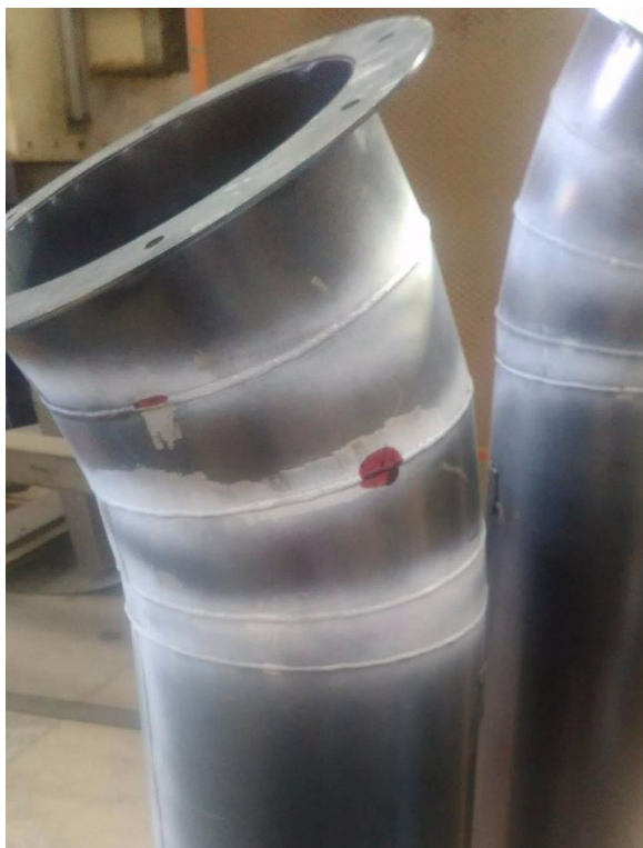
Figura 2-2. Inspección tintas penetrantes – Angloamerican.
