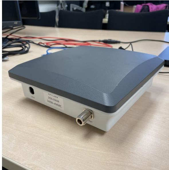
Figura 21: Foto de RAK7391 dentro del cierre exterior. Fuente: Creación propia.
