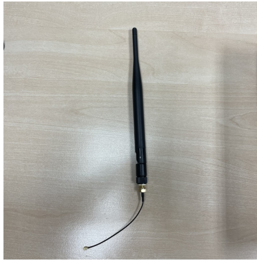
Figura 23: Antena LoRaWAN. Fuente: Creación propia.
