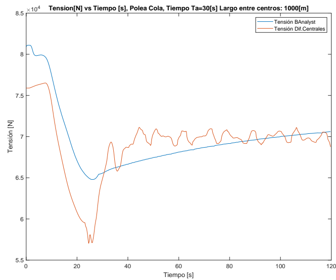
Figura 6.17: Tensión en la polea de cola comparada con la tensión obtenida por el programa “Belt Analyst”.
