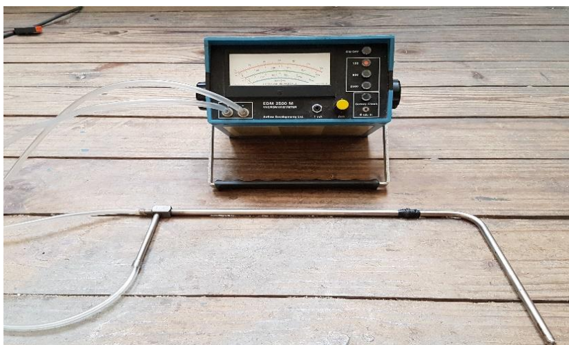
Figura 35: Tubo pitot y micromanómetro utilizado para la calibración de la placa orificio.
