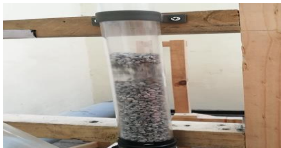
Figura 17: Burbujeo de material al inicio del ensayo de purga.
