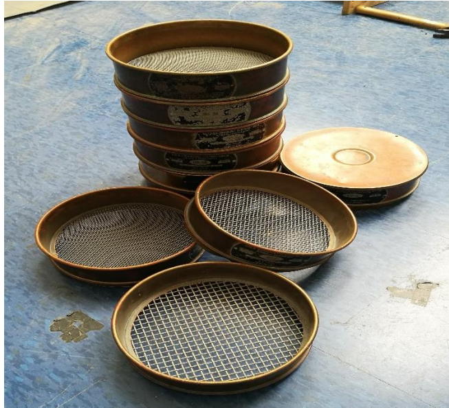
Figura 36: Juego de mallas granulométricas disponibles en el CITRAM.
