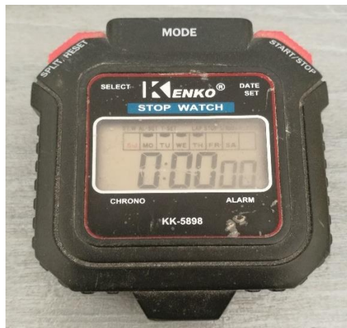
Figura 37: Cronómetro digital utilizado para medir el tiempo de descenso del material en el silo alimentador.
