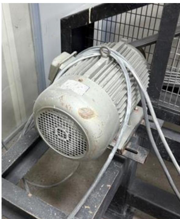
Figura 2-8 Fotografía motor eléctrico de chancador primario Salas. Fuente: Captura propia en laboratorio de conminución.
