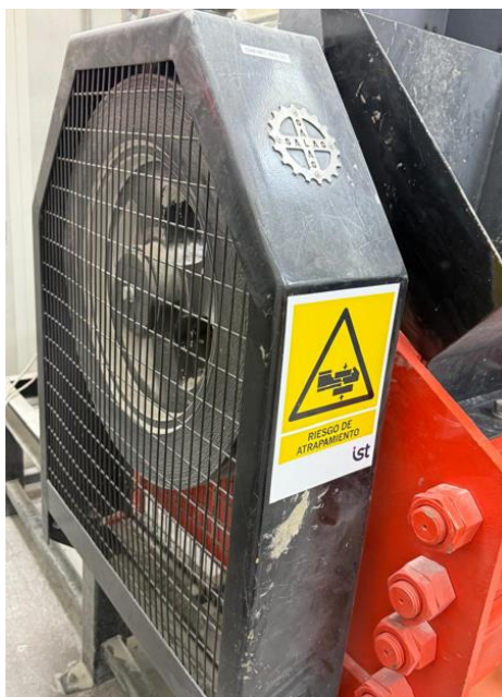
Figura 2-6 Fotografía de protección de seguridad chancador primario Salas.
