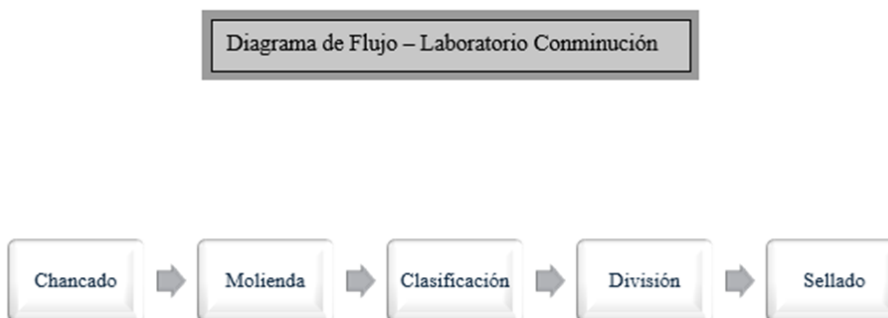
Figura 1-2 Diagrama de flujo del laboratorio de conminución.
