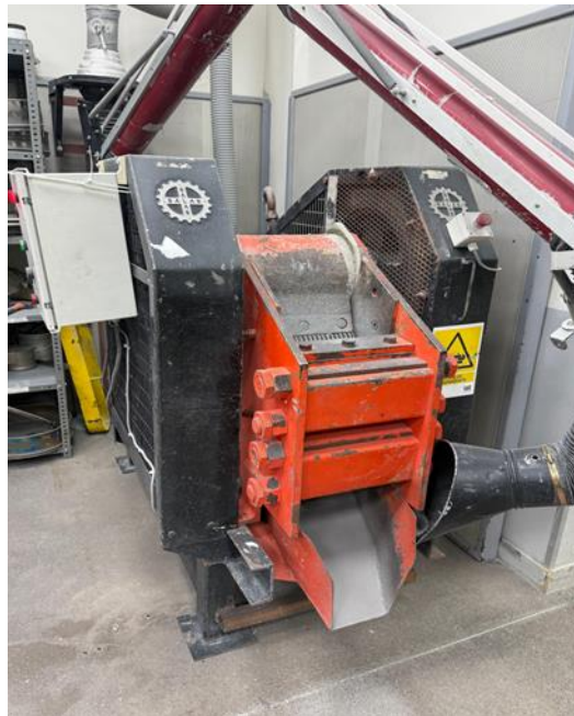
Figura 2-2 Fotografía de chancador primario Salas.
