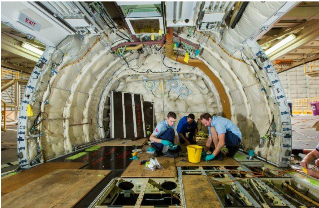
Figura 3-3: Ejemplo de una inspección estructural por mantenimiento de oportunidad
