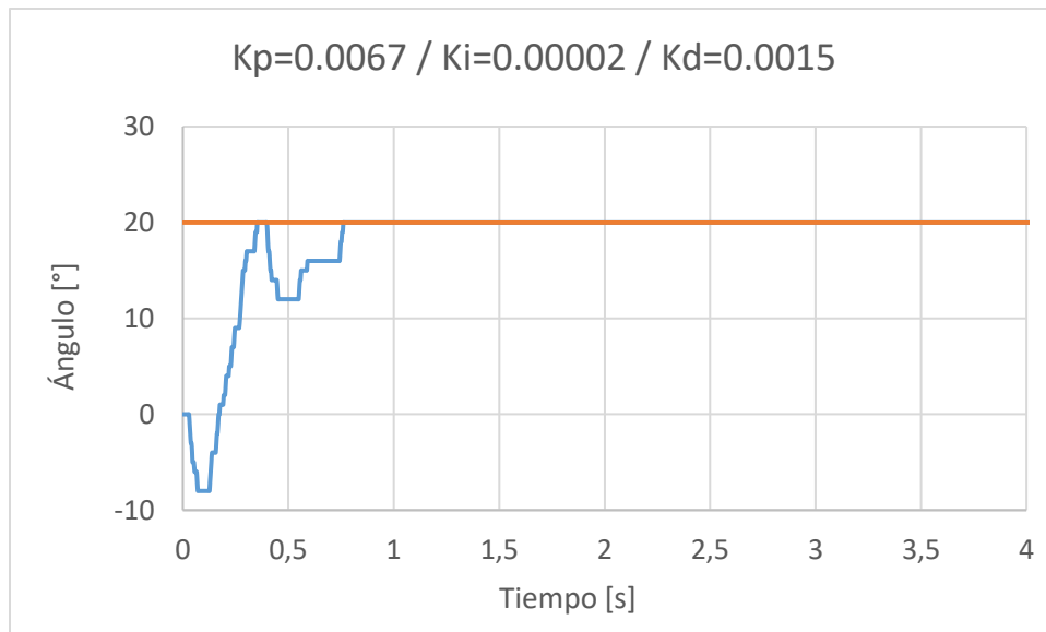
Figura 3.5: Tiempo de respuesta de la muñeca con control PI , al seguir una referencia de \theta = 20 [°]
