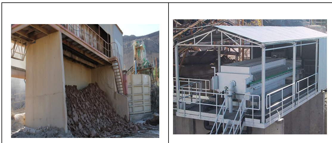
Ilustración 7 Filtro prensa en planta de áridos Marraque 5 , Almeria España y filtro prensa Ampmineral 6
