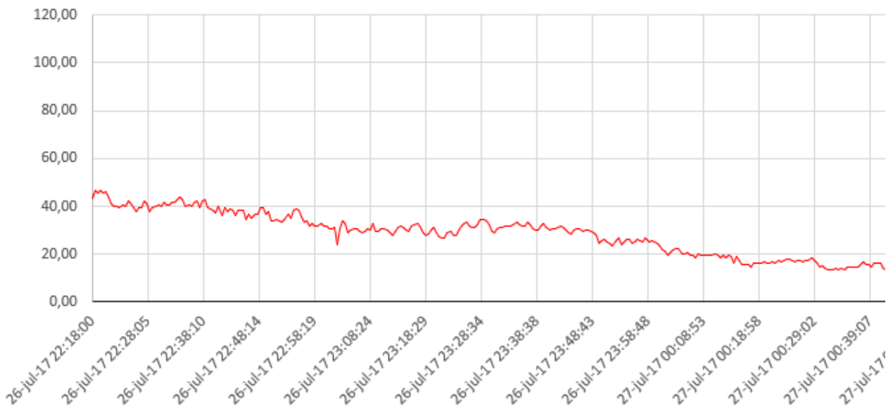
Figura 5.9. Caudal impulsión planta, parada de bomba N°2 (consumo clientes).
