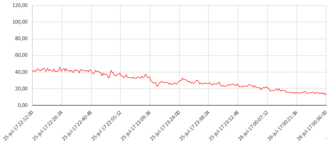
Figura 5.17. Caudal impulsión planta, parada de bomba N°4 (consumo clientes).
