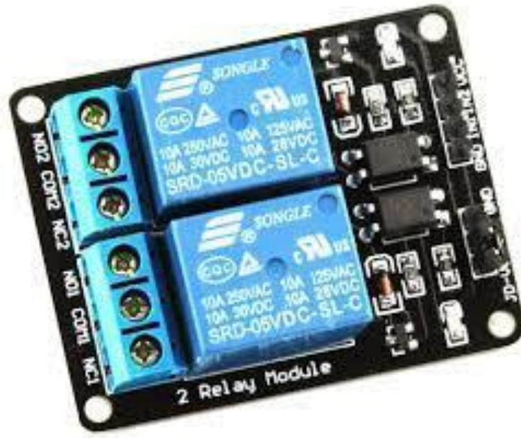
Fuente: https://ardumotica.cl/producto/modulo-rele-5v-2-canales-optocoplados/ Figura 1-5. Módulo de relé de 2 canales
