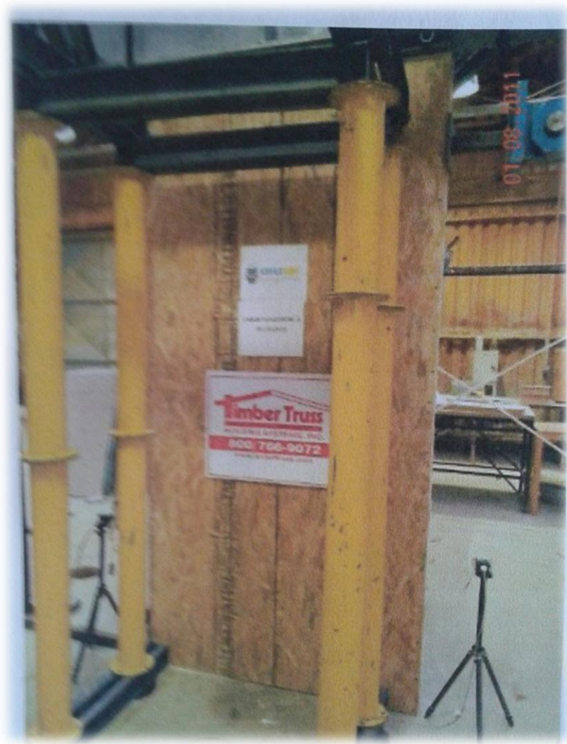
(Figura 4.1 Implementación del ensayo de carga horizontal.)
