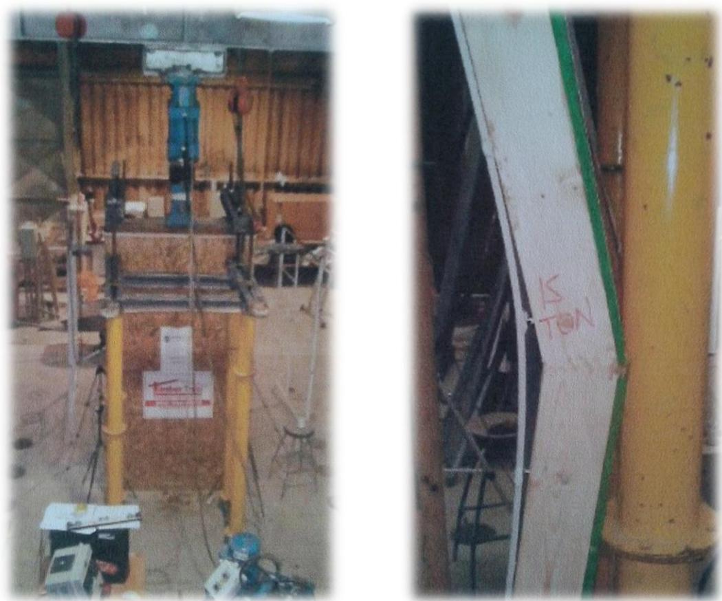
(Figuras 4.6 Implementación del ensayo de compresión y falla asociado a los ensayos.)
