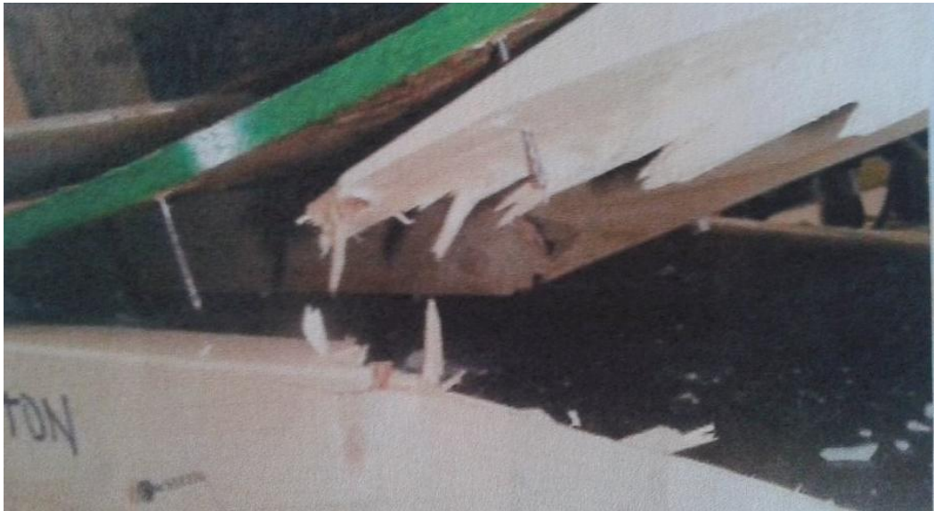
(Figura 4.5 Modo de falla por flexión para paneles cargados.)
