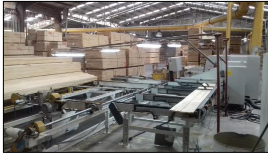
Figura 2-12 Moldurera WEINNIG para fabricación de molduras y perfiles
