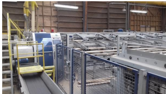
Figura 2-6 Trozadores OPTICUT para trozado de madera y eliminación de defectos
