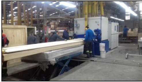
Figura 2-14 Lijado y reparado en Maquina Calibradora
