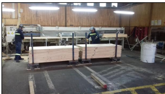
Figura 2-9 Fabricación de Blanks a la salida de Finger HS 120 GRECON
