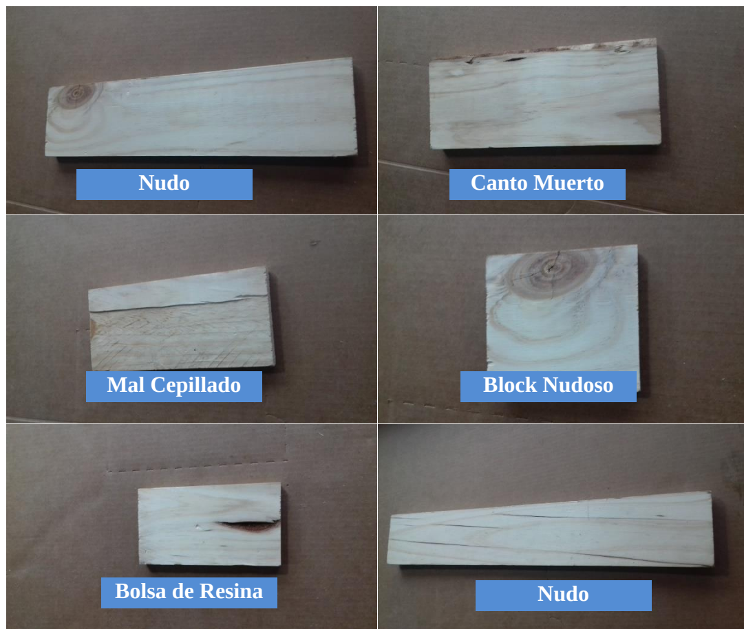
Figura 2-7 Defectos eliminados por escáner WEINIG
