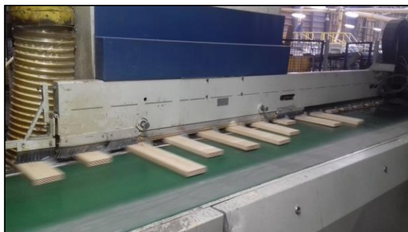
Figura 2-8 Fabricación de dientes en Block Finger Joint
