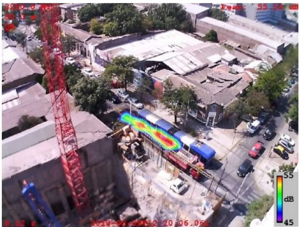
Ilustración N° 35 Localización de fuente de ruido móvil a 30 m de distancia y 3250 Hz, extraída de Covexverde.
