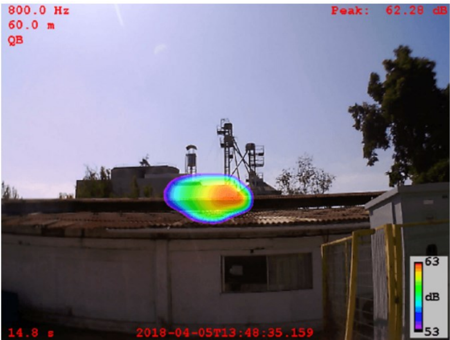
Ilustración N° 34: Imagen captada por cámara acústica localización de fuente de ruido industrial en altura a 60 m de distancia y 800 Hz, extraída de codexverde.
