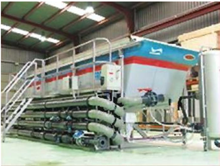
Figura 2.3: Previsualización de máquina de flotación por aire disuelto Fuente VIII: Toro Equipament (2020)
