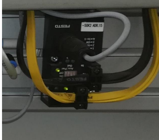
Figura 2-26. Esclavo AS-i para pistón neumático
