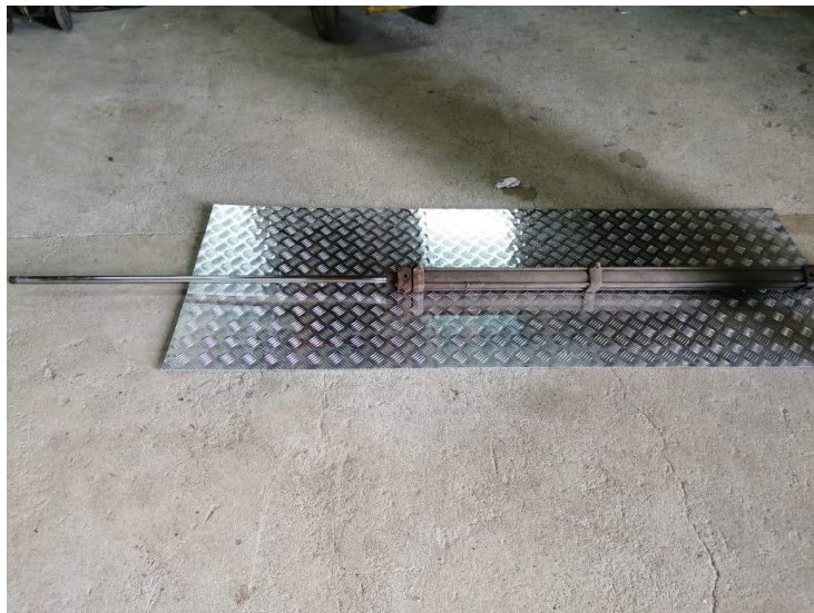
Figura 2-13 Cilindro hidráulico con el pistón extendido
