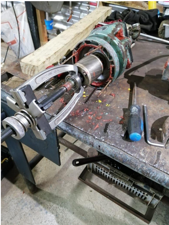
Figura 3-4 Extracción rodamiento de motor de la plataforma.
