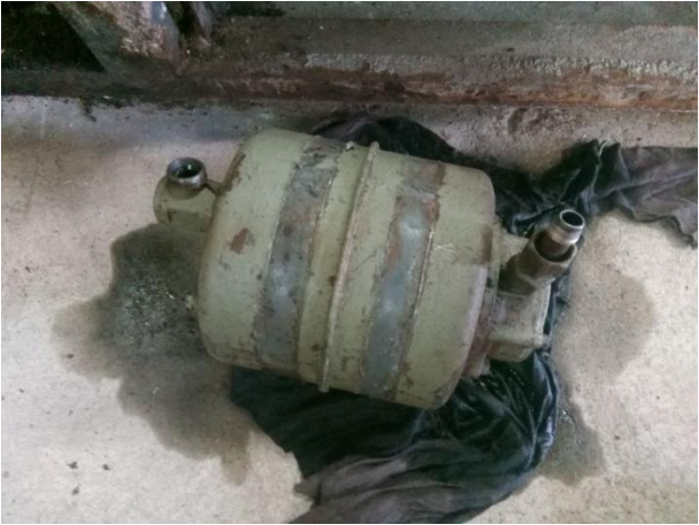
Figura 2-8 Depósito del fluido hidráulico desmontado y su simbología
