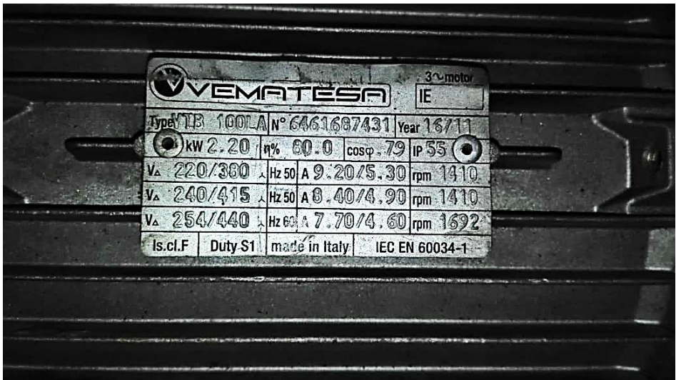
Figura 2-25 Placa del motor eléctrico sierra sin fin Buster II Fuente: Elaboración propia
