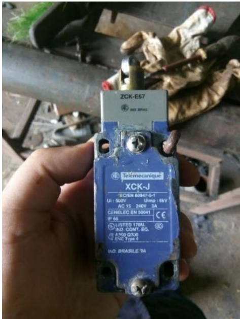
Figura 2-14 Terminal de carrera del sistema electrico Fuente: Elaboración propia
