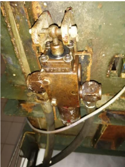
Figura 2-10 Válvula de alivio del circuito hidráulico y su simbología Fuentes: Elaboración propia
