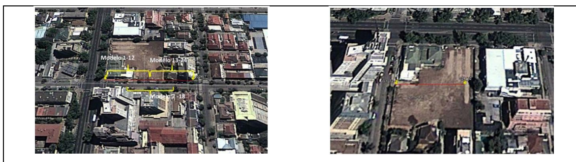
Figura 4-3.- Modelo de tendido para colocación de tendido de geófonos.
