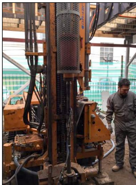
Figura 4-8.- Maquina ROLATEC y equipo SPT automático.
