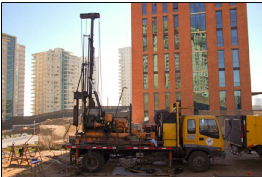
Figura 4-2.- Sonda ACKER DRILL MS135 con martillo automático
