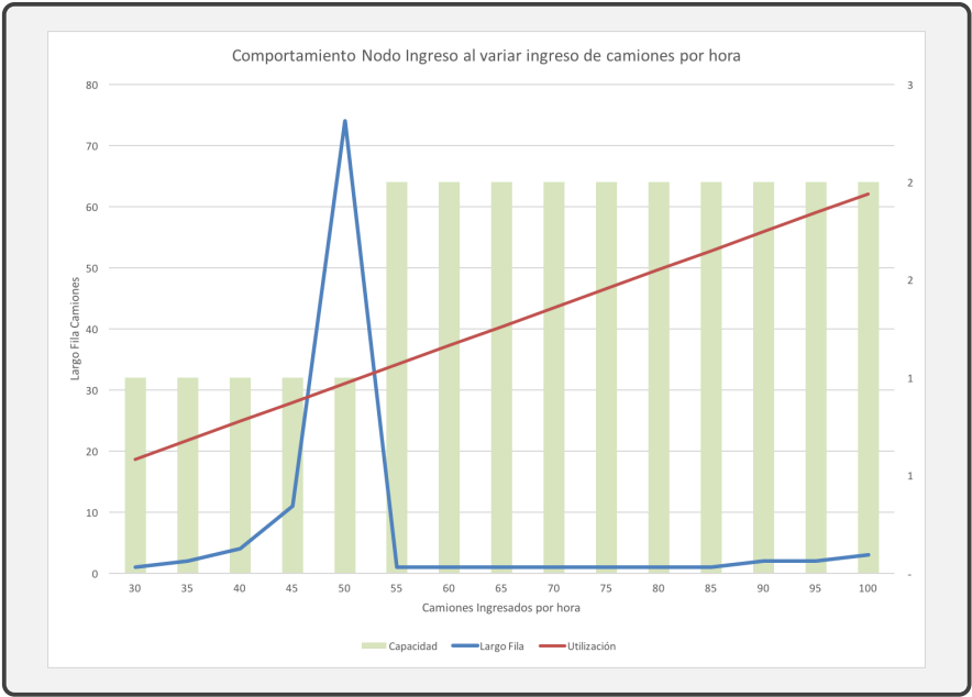
Figura 7.1: Comportamiento en el nodo ingreso al cambiar el valor de \lambda
