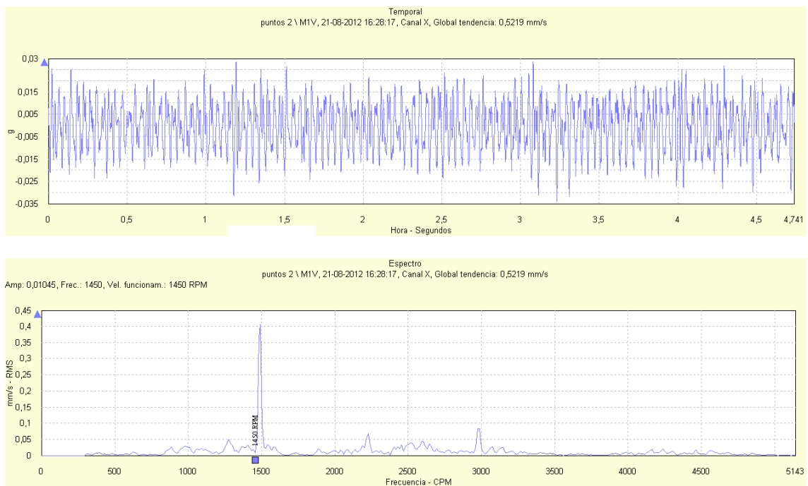
Figura 109: Señal temporal y espectro de vibración para la dirección vertical del ducto de succión de la bomba RABI 8 para la condición de operación de la bomba RABI 7.
