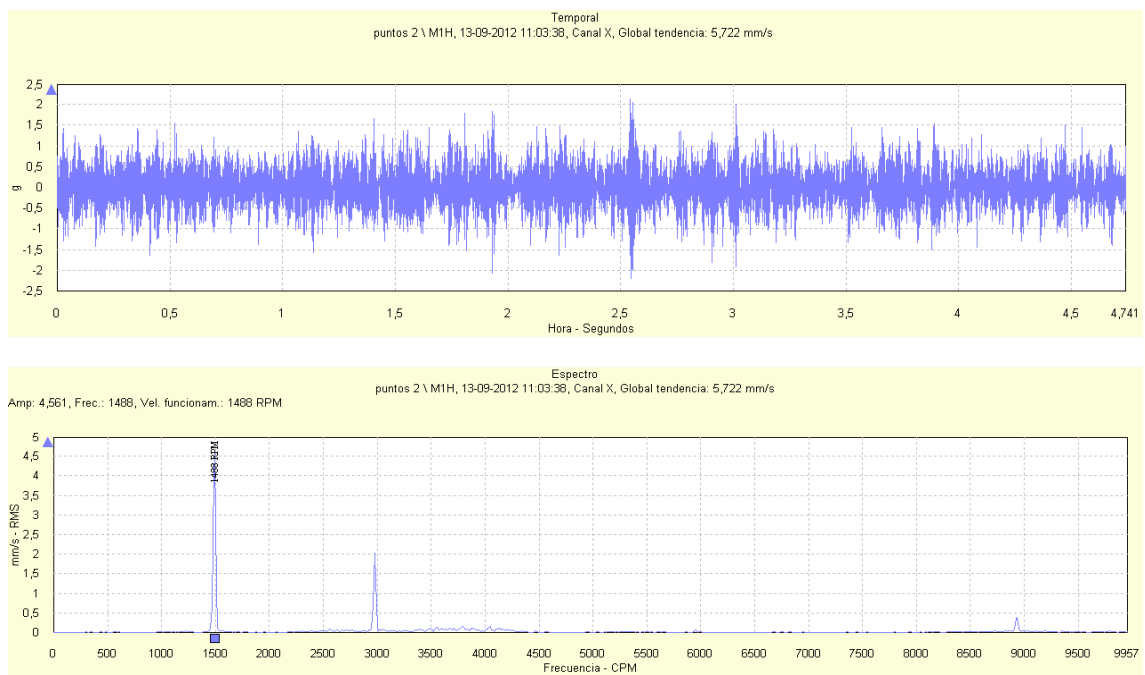
Figura 124: Señal temporal y espectro de vibración para la dirección horizontal del ducto de succión de la bomba RABI 6 para un flujo impulsado de 1 000 m 3 /h
