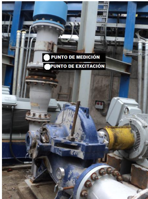
Figura 113, Configuración de excitación y adquisición en ensayo de respuesta ante impacto en bomba RABI8
