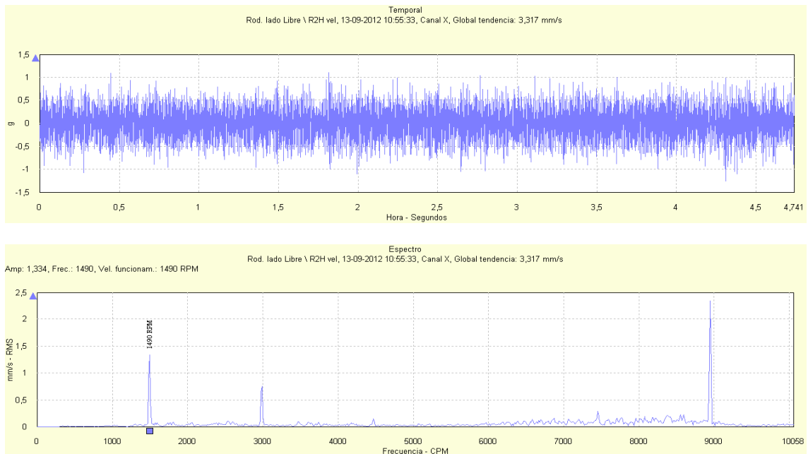
Figura 140: Señal temporal y espectro de vibración para la dirección horizontal del porta-rodamientos lado libre de la bomba RABI 6 para un flujo impulsado de 800 m 3 /h
