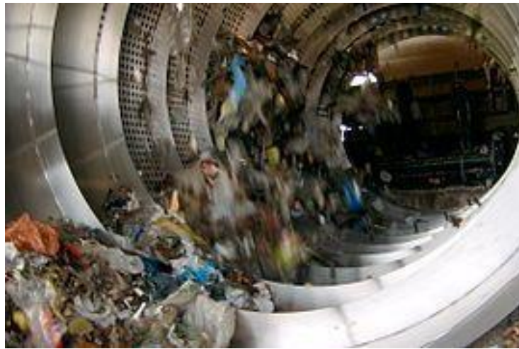
Figura 9: Representación del funcionamiento de un Trommel [30].
