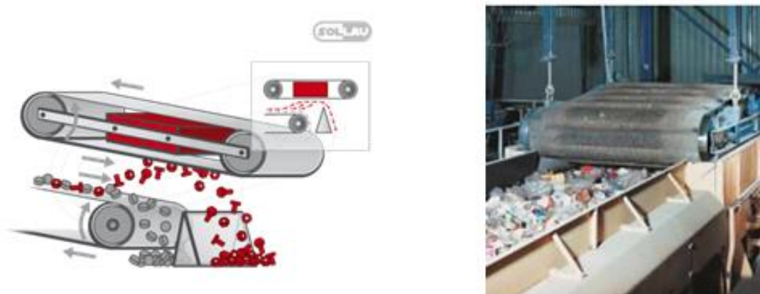
Figura 10: Representación del funcionamiento de un separador magnético.
