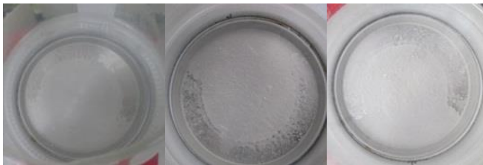
Imagen 8.10: Fotos de los estados del hervidor controlado zona del comedor del laboratorio, al finalizar las semanas 7, 8 y 9 (de izquierda a derecha, de arriba abajo).
