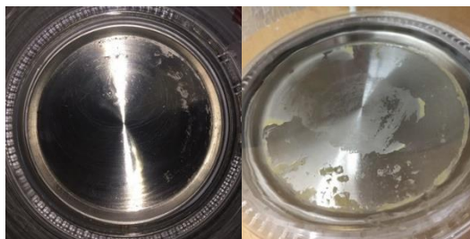
Imagen 8.12: Condición final de los hervidores controlados de la línea con tratamiento a la izquierda y sin tratamiento a derecha.
