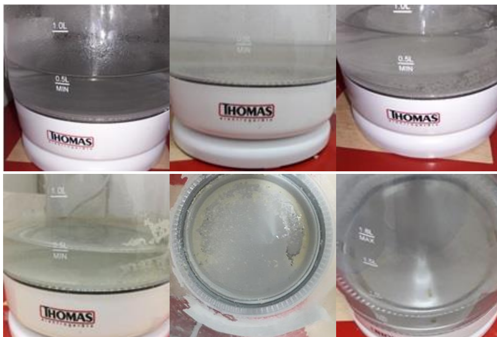
Imagen 8.6: Fotos de los estados del hervidor controlado de la zona para café, al finalizar las semanas 1, 2, 3, 4, 5 y 6 (de izquierda a derecha, de arriba abajo).
