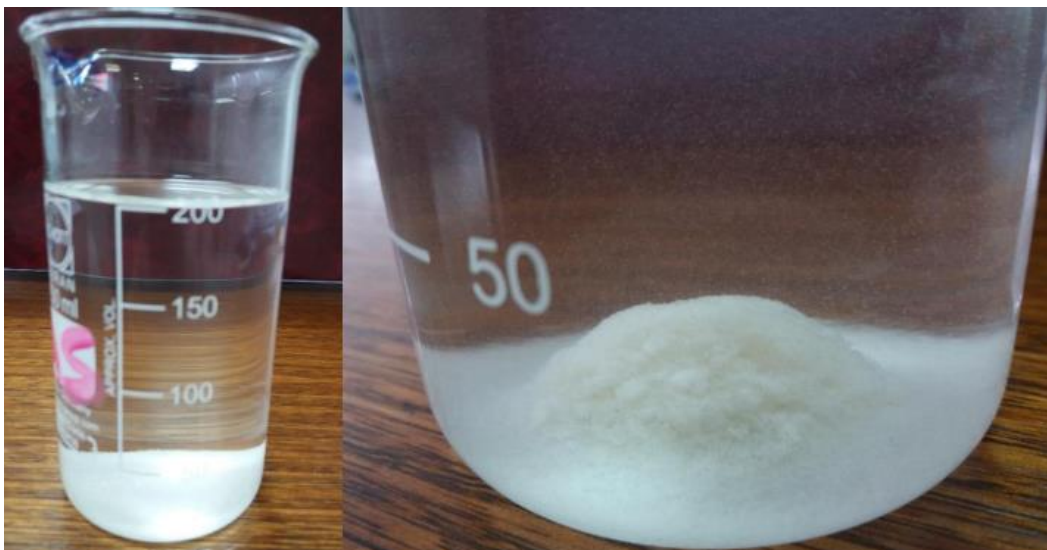
Imagen 8.14: Condición final del vaso precipitado y los depósitos decantados, transcurridos 56 [min] en reposo.
