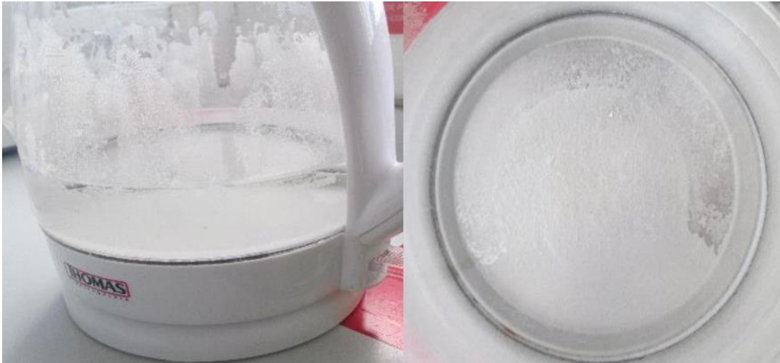
Imagen 8.13: Residuos en el fondo del hervidor controlado (agua tratada), luego de 4 semanas de uso.
