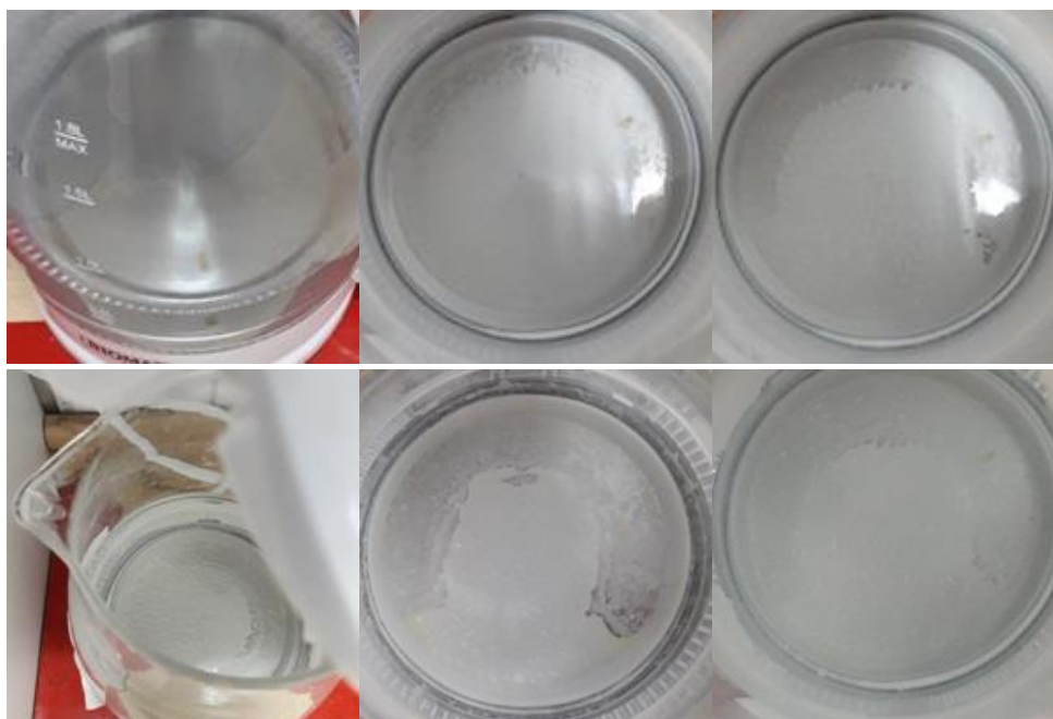
Imagen 8.7: Fotos de los estados del hervidor controlado de la zona para café, al finalizar las semanas 7, 8, 9, 10, 11 y 12 (de izquierda a derecha, de arriba abajo).
