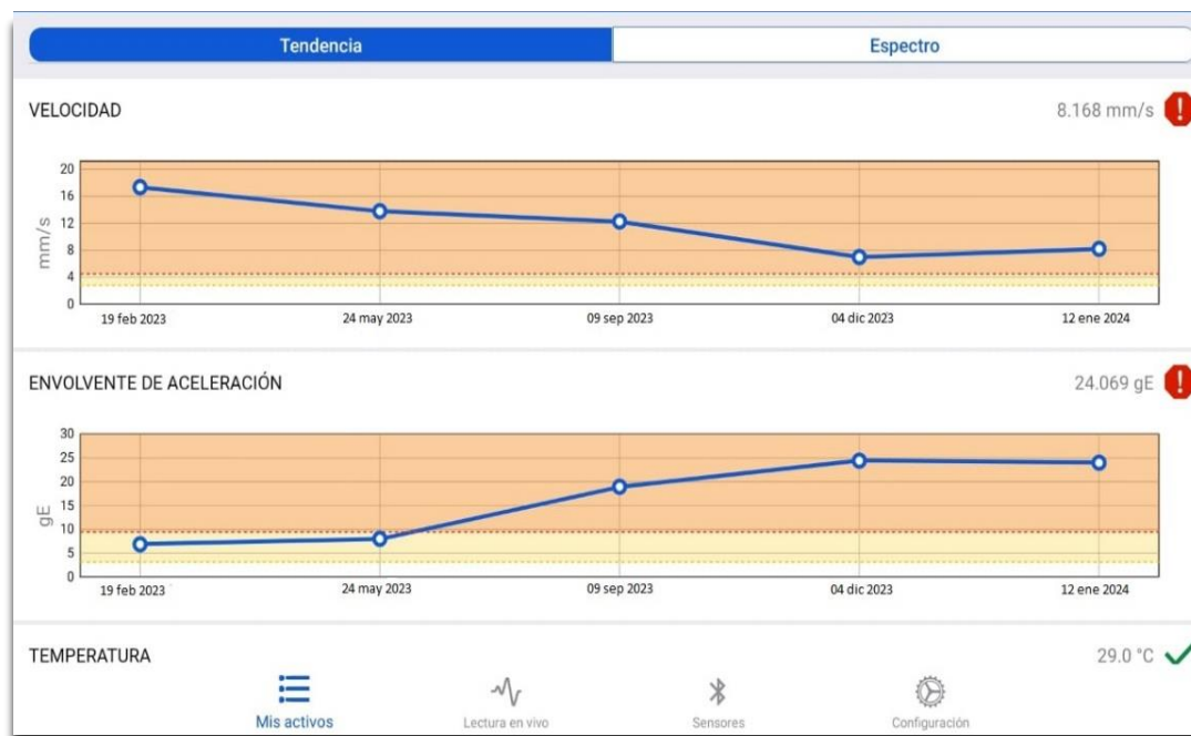
Figura 3-13. Tendencias de vibraciones en soplador de calentador 410.
