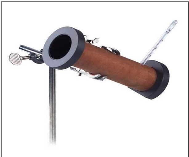
Figura 17: Bolómetro para medición de radiación térmica
