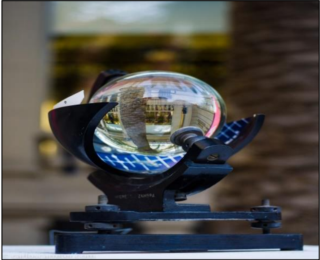
Figura 16: Heliómetro de medición solar “Campbell Stokes”
