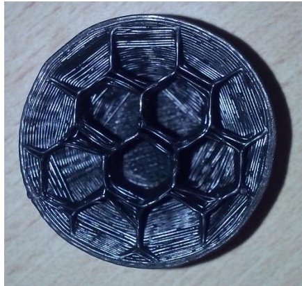
Figura 39: Vista en corte de una de las puntas superiores del ladrillo. Se puede apreciar la densidad de impresión 15[%].
