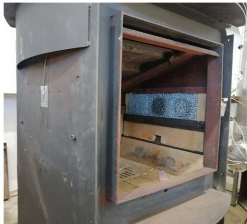
Ilustración 11: Incorporación de MPI en la estufa y sujeción “tipo prensa”. Fuente: Elaboración propia
