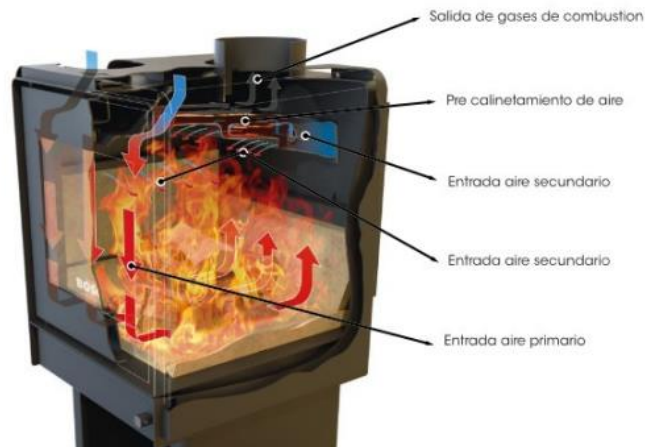
Ilustración 10: Esquema del sistema de doble combustión. Fuente: Bosca (2017)
