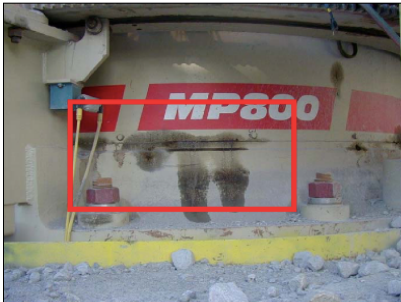
Figura 1-14: Fuga de aceite por rotura de línea (Manual mantenimiento chancador METSO)
