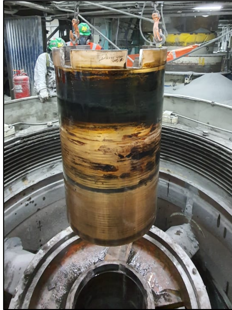
Figura 1-15: Buje bronce quemado por falla en lubricación (registro personal).
