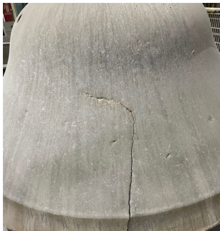
Figura 1-12: Fisura manto cabeza chancador (registro personal).
