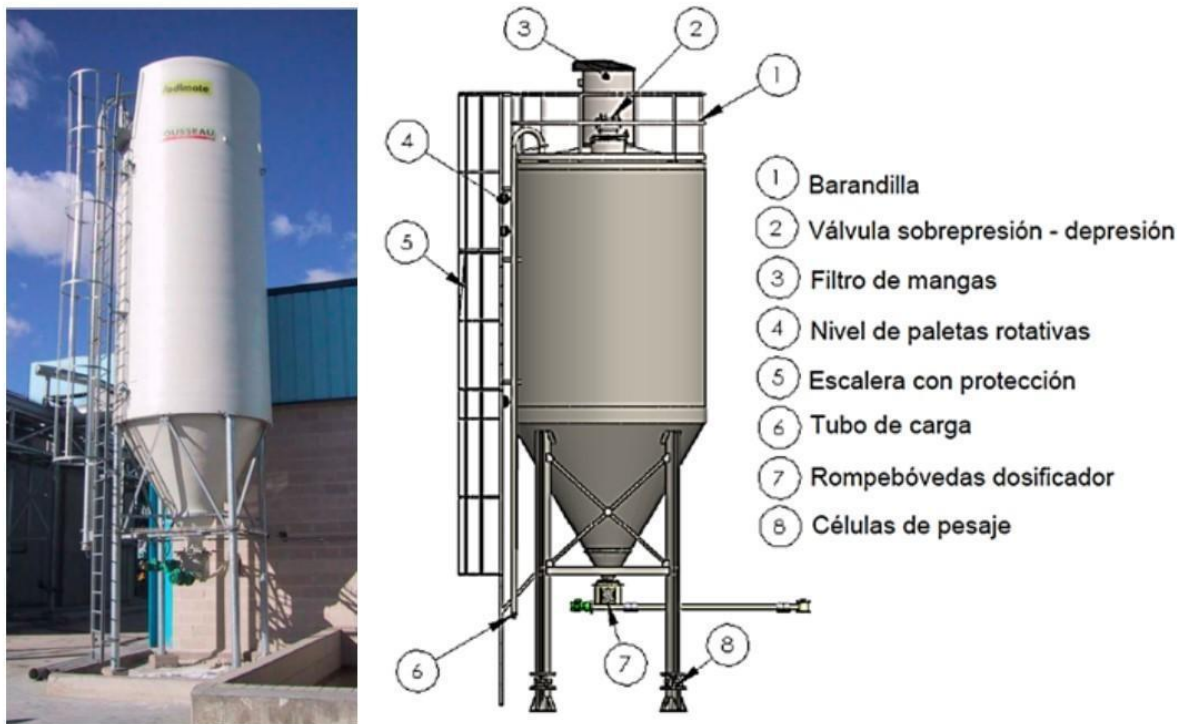
Figura 8: Partes de un silo industrial. Fuente: INESA.
