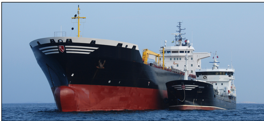
Figura N° 1-2: Nave menor realizando operaciones de Alije de hidrocarburos a Nave mayor (SOCOMET)
