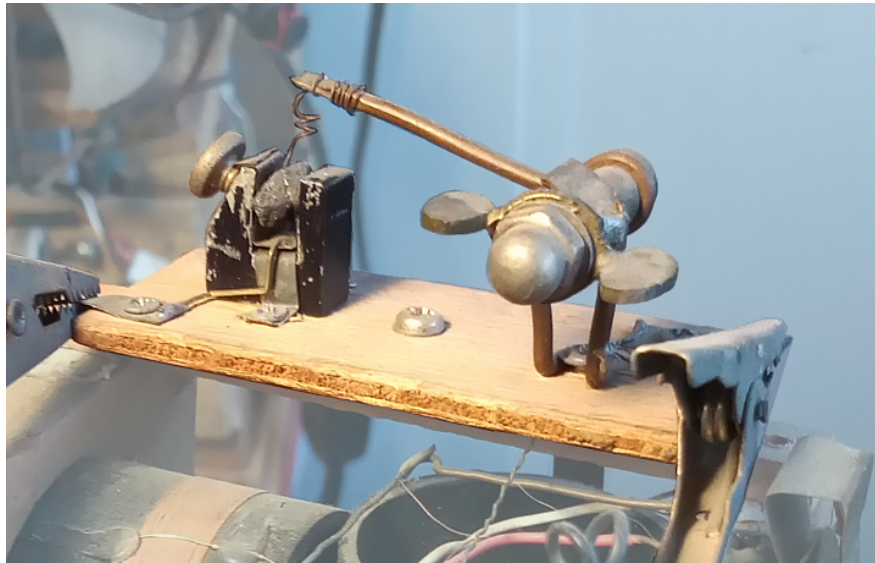
Figura 1.5: Detector de bigote de gato con un cristal de galena, en un receptor de radio primitivo.
